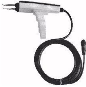
قد تكون الأغنام هي من أكثر الحيوانات صعوبة الصعق كهربائيا وذلك بسبب مقاومة الصوف لمرور التيار الكهربائي. لذلك يجب أن تكون الأقطاب الكهربائية لجهاز الصعق ذات تصميم معين يسهل اختراق التيار الكهربائي للصوف للحصول على تماس جيد مع رأس الحيوان (شكل 7). ان الأغنام الكبيرة الحجم لها مقاومة عالية لمرور تدفق التيار الكهربائي من خلال اجسامها
